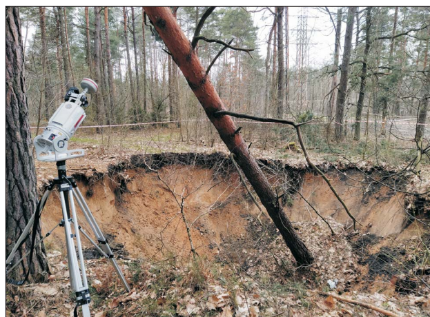
Ryc. 1. Naziemne skanowanie laserowe zapadliska utworzonego w pobliżu linii kolejowej prowadzącej do elektrowni Siersza . Fot. Z. Perski
