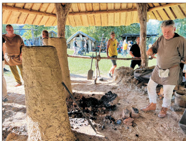
Ryc. 1. Rekonstrukcja pieców dymarskich oraz kloc żużla z rozebranej dymarki po zakończeniu wytopu. Fot. A. Józwiak
