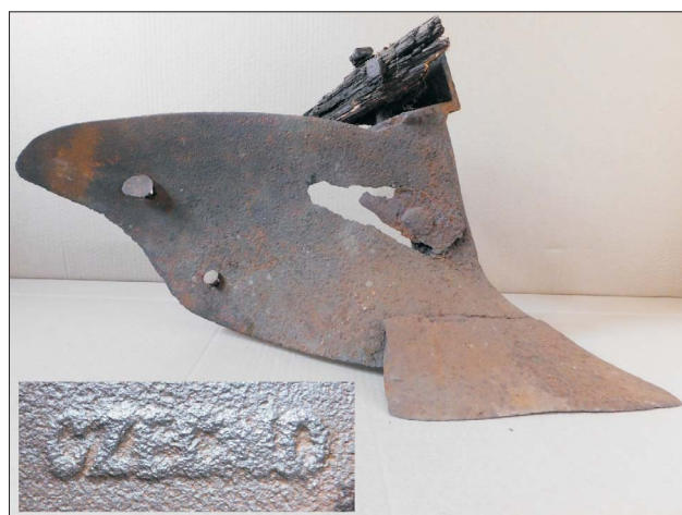
Ryc. 8. Odkładnica pługa z sygnaturą CZECNO, odlana w Hucie Wojciechów, XIX w. Zbiory B. Kozaka. Fot. B. Kozak
