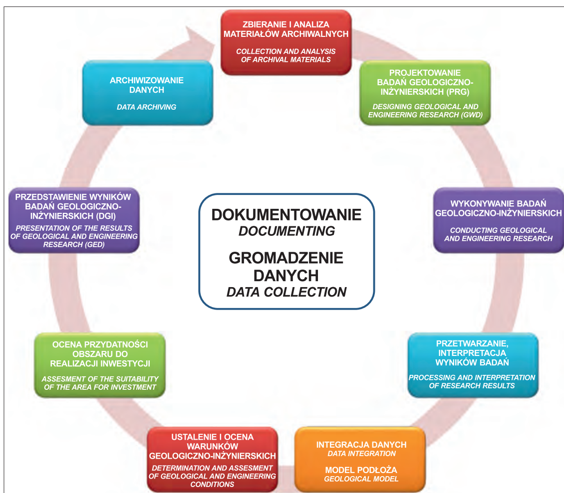
Ryc. 7. Proces dokumentowania geologiczno-inżynierskiego na obszarach morskich (Majer i in., 2024) Fig. 7. The process of geological and engineering documentation in marine areas (Majer et al., 2024)
