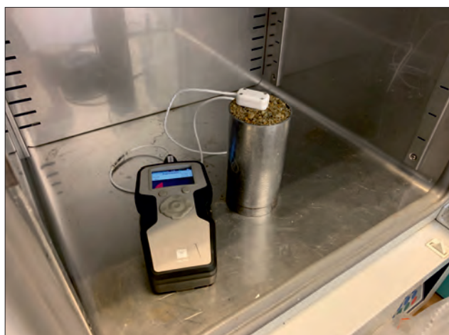
Ryc. 10. Badanie termiczne próbki gruntu za pomocą igły termicznej
