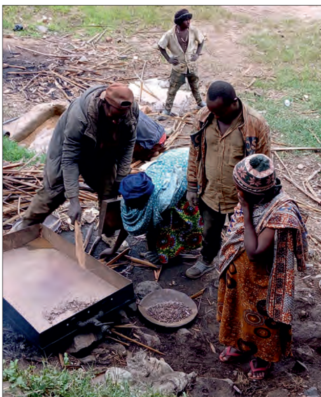
Ryc. 5. Wzbogacanie rudy cyny w zakładzie przerobczym przy kopalni Isingiro-Kitagati na granicy z Tanzanią. Fot. K. Wójcik
