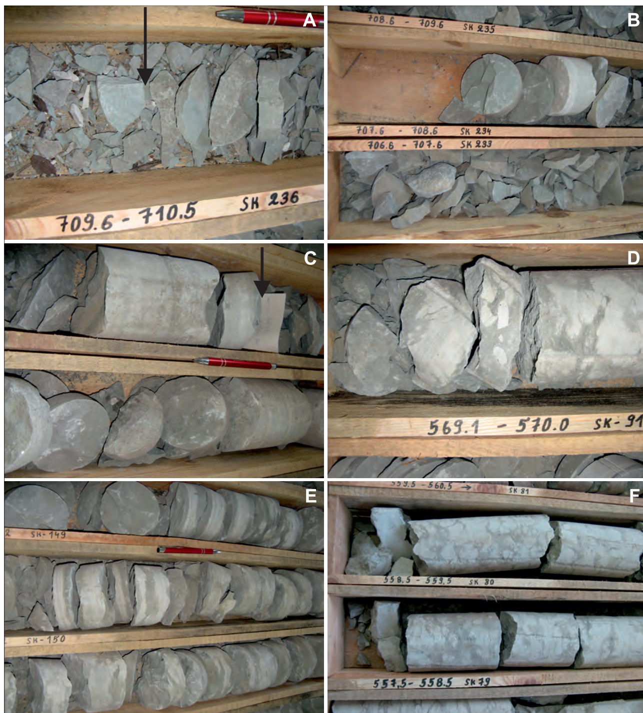
Ryc. 3. Litologia utworów syluru w otworze Widowo IG 1. A – granica ordowiku górnego (kat, formacja ze Stadnik (Fm), prawa strona zdjęcia) z landowerem (telych, formacja z Wrotnowa), głęb. 710 m; B – mułowce/iłowce i mułowce margliste, telych, formacja z Wrotnowa, głęb. 708,6–706,6 m; C – kontakt beżowo-zielonych mułowców marglistych formacji z Wrotnowa z szarymi, twardymi, dolomitycznymi wapieniami formacji z Terespola, (strzałka), głęb. 706 m; D – gruzłowe wapień margliste i dolomityczne, wenlok (sheinwood), formacja z Terespola, głęb. 569,1–570,0 m; E – naprzemianległe warstewki wapienia (marglistego) i iłowca marglistego; nieliczne skamieniałości na powierzchniach warstw, formacja z Terespola, głęb. 701 m; F – wapień marglisty i dolomityczny o strukturze gruzłowej, formacja z Terespola, głęb. 558,5–560,5 m
