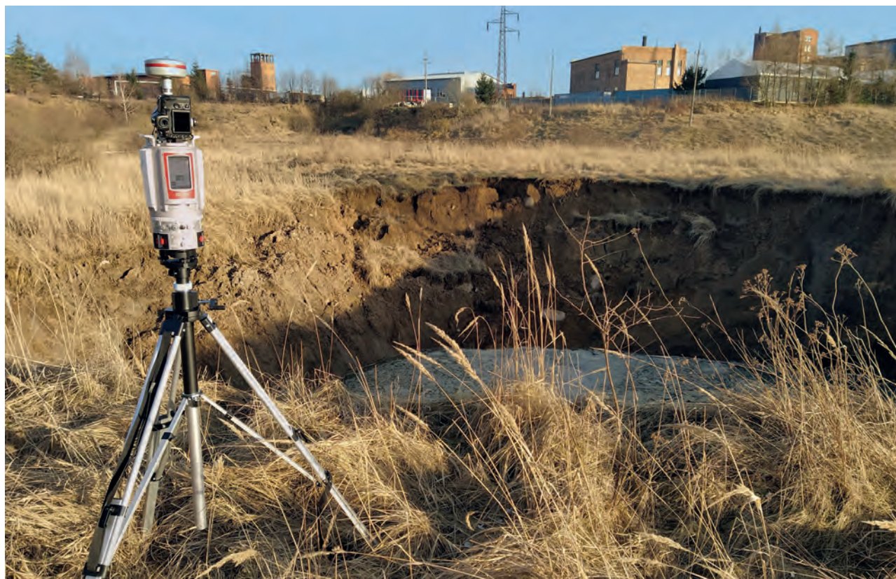
Ryc. 4. Naziemny skaning laserowy zapadliska powstałego w lutym 2021 r. Gmina Wapno. Obie fot. Z. Perski
