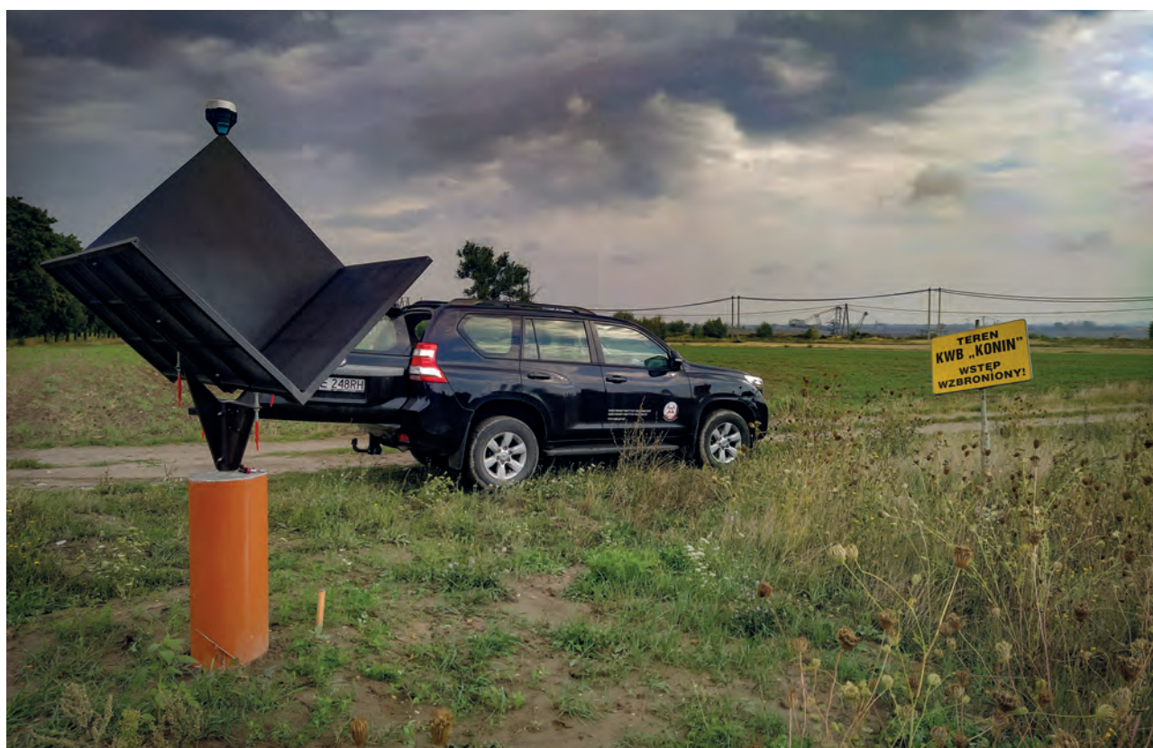
Ryc. 6. Reflektor radarowy trójścienny do monitorowania deformacji powierzchni terenu na terenie KWB Konin
