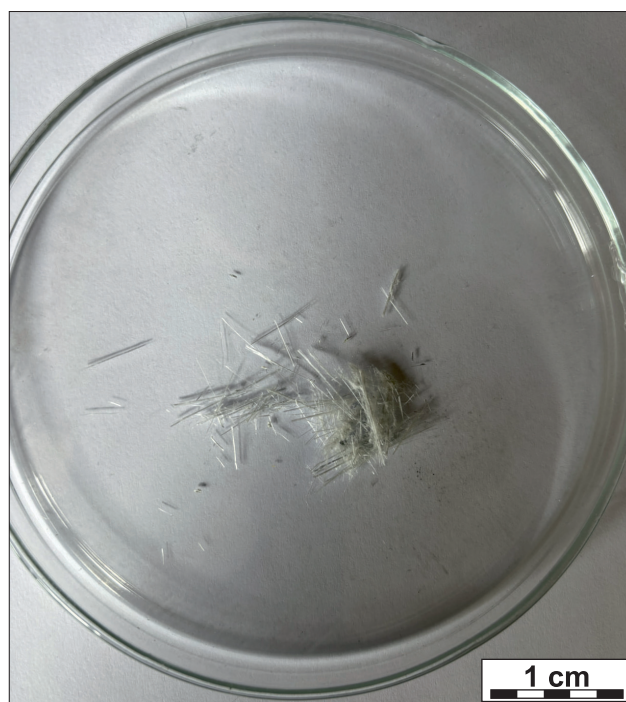
Ryc. 3. Minerale o pokroju włóknistym i blaszkowym zeszkrobane z powierzchni serpentynitu z Nasławic. Fot. M. Dumańska-Słowik
