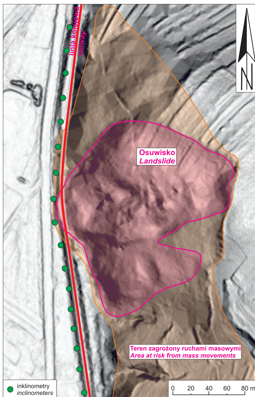
Ryc. 9. Lokalizacja inklinometrów w stosunku do osuwiska na NMT z 2024 r. Fig. 9. Location of inclinometers in relation to the landslide on the 2024 DTM
