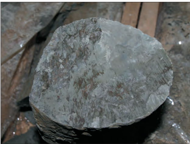
Ryc. 2. Powierzchnia poślizgu osuwiska z widocznymi rysami ślizgowymi rozwinięta w obrębie ilów miocenijskich Fig. 2. Landslide slip surface with visible sliding cracks developed within Miocene clays
