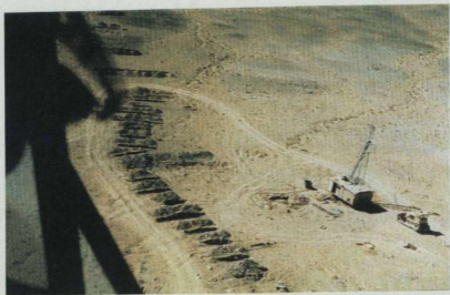
Masyw ługijngolski. Jedna ze stref karbonatytowych, poprzecinana licznymi rowami badawczymi. Z prawej strony wiertnica do wykonywania ukośnych otworów.
