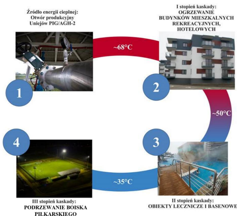
Fig. 5.3.2. Schemat głównych etapów kaskadowego wykorzystania energii geotermalnej w Uniejowie (opracowanie własne na podstawie geotermia-uniejow.pl i uniejow.pl/energia-geotermalna/ )
