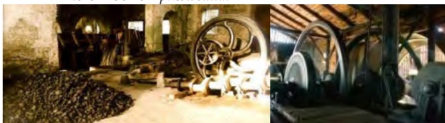
Sielpia Wielka – fragment zakładów metalowych (po lewej), Małenica – „Małenicki szaleniec” (po prawej) – terminem tym robotnicy zatrudnieni w Małenickiej Fabryce Żelaza określali wielkie 30-tonowe koło zamachowe, obracające się z piekielną szybkością.
