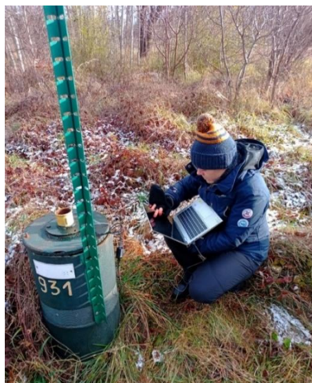
Ryc. 2.1. Prace kontrolne i serwisowe urządzeń automatycznych na stacji hydrogeologicznej wyposażonej w automatyczne urządzenia pomiarowe.
