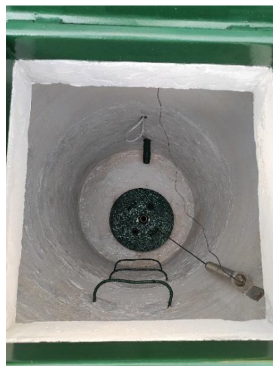
Ryc. 9.4. Punkt SOBWP numer II/1479 Głębokie (woj. lubelskie) po wykonaniu prac remontowych, po prawej widoczny moduł automatyki pomiarowej.
