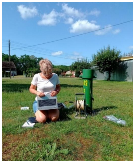
Ryc. 2.1. Prace kontrolne i serwisowe urządzeń automatycznych na stacji hydrogeologicznej wyposażonej w automatyczne urządzenia pomiarowe.
