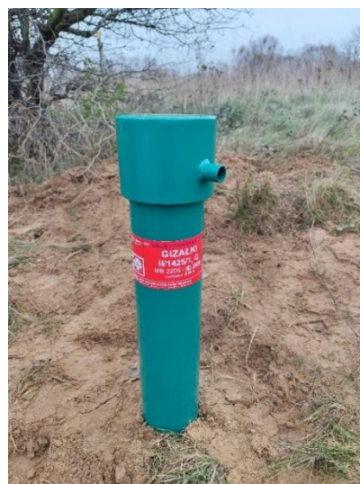
Ryc. 9.2. Punkt obserwacyjny II/1425 Giżałki (woj. wielkopolskie) w trakcie prac związanych z wymianą obudowy piezometrycznej.
