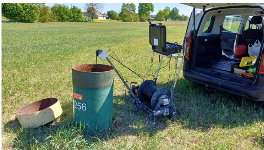
Ryc. 8.1. Inspekcja specjalistyczną kamerą otworu ID 5789 Sarzyn (fot. J. Kochanowski)
