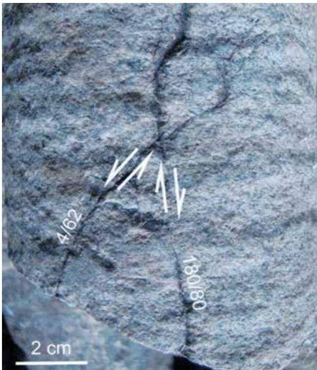
Fig. 14. Dwa zespoły komplementarnych ścięć normalnych stwierdzonych w otworze Nidzica IG 1, głęb. 2316,0–2317,8 m
