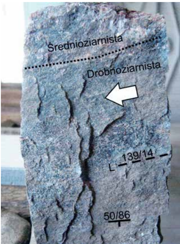
Fig. 21. Powierzchnia ślizgowa (L) subwertykalnego mezouskoku prawoprzesuwczego z wyraźnie zaznaczającymi się rysami i zadziorami tektonicznymi; otwór Nidzica IG 1, głęb. 2317,8–2319,0 m
