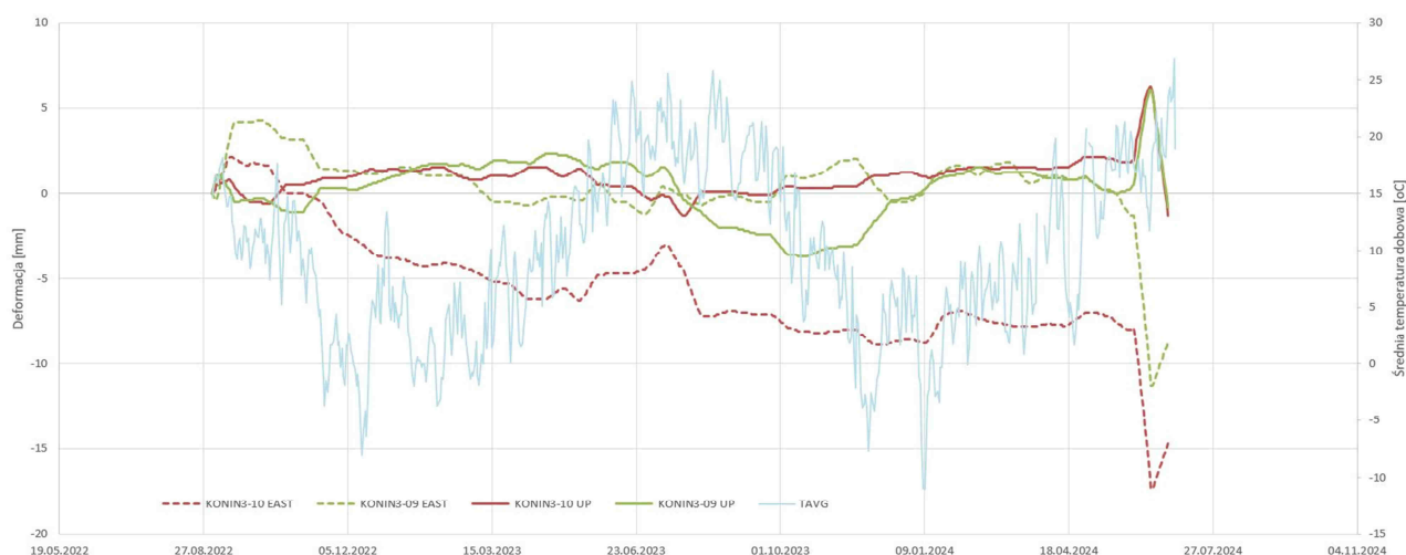
Rys. 18 Serie czasowe deformacji dla reflektorów obszaru Pątnów na tle zmienności średnich temperatur dobowych. Składowa pionowa (UP) i pozioma w kierunku W-E (EAST).
