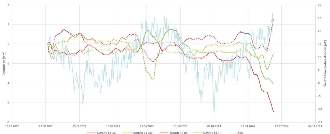
Rys. 20 Serie czasowe deformacji dla reflektorów obszaru Drzewce na tle zmienności średnich temperatur dobowych. Składowa pionowa (UP) i pozioma w kierunku W-E (EAST).
