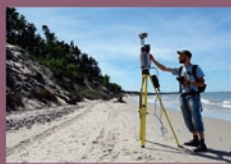
Wykorzystanie metody skaningu laserowego do monitorowania brzoza morską Bałtyku.
