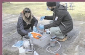
Terenowe oznaczenia parametrów jakości wód podziemnych i pobór próbek do badań laboratoryjnych.
