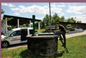
Pomiar poziomu zwierciadła wód podziemnych na stacji hydrogeologicznej Rechin.
