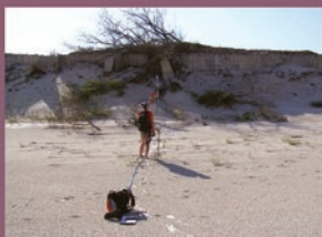
Pomiar podatności magnetycznej i gradientu napięcia pola magnetycznego na nadmorskiej plaży.
