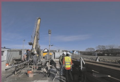
Otwór "Krajno PIG-1" wykonany na zboczach gór Strzanej w celu oceny potencjału występowania rud metali.
