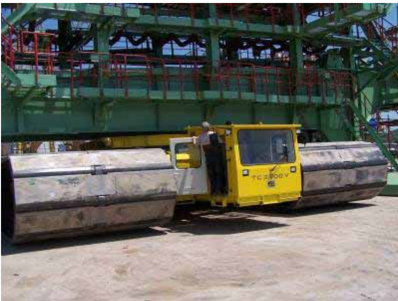
Rysunek 34. Transporter TC2000V do transportu stacji napędowych w KWB „Belchatów” –projekt Poltegor-Projekt, wykonanie FUGO Konin
