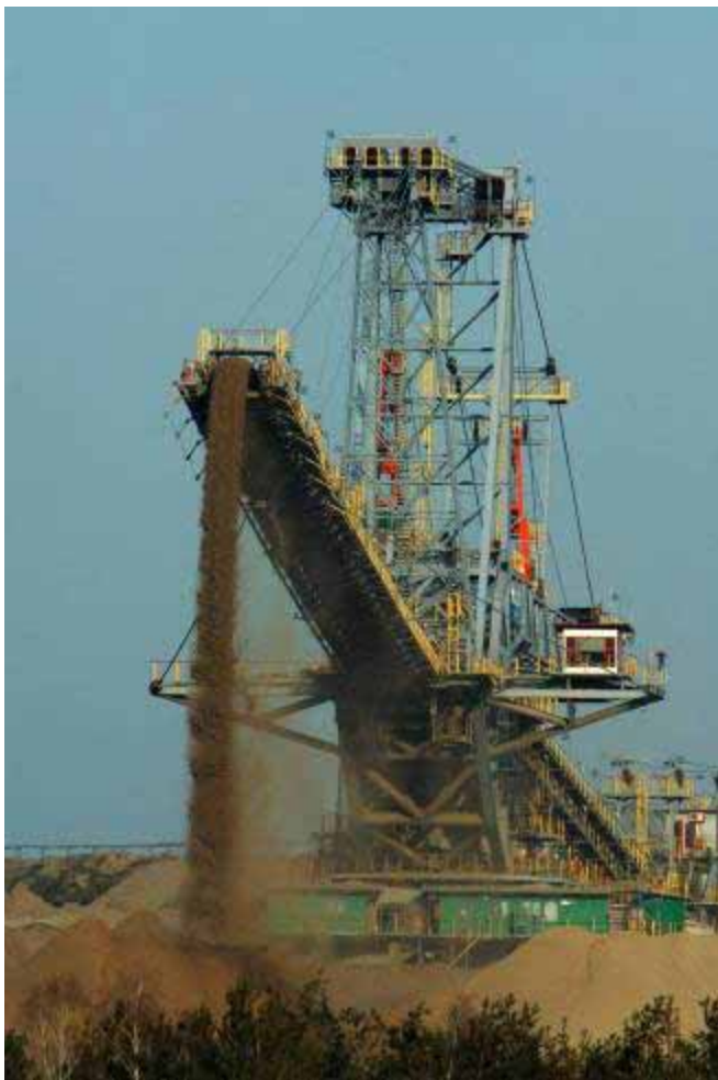
Rysunek 32. Zwałowarka ZGOT-15 400 w KWB „Belchatów” –projekt SKW Zgorzelec, wykonanie FAMAK Kluczbork, ZPR Belchatów i ZRE Katowice
