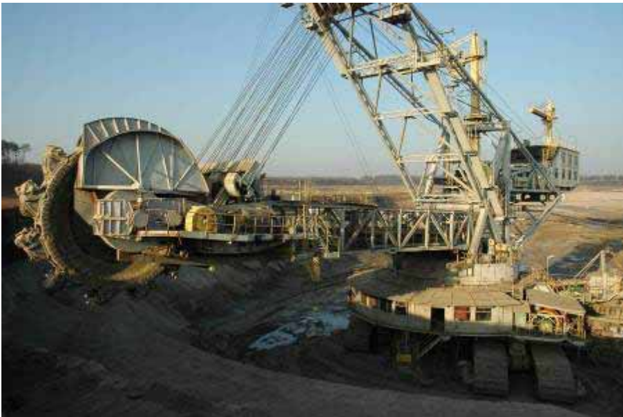
Rysunek 31. Koparka KWK-1500s w KWB „Konin” –projekt i wykonanie FAMAGO Zgorzelec
