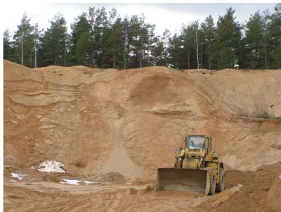
ryc. 33: Wydobycie piasku i żwiru w żwirowni w Przewoźnikach, które wykorzystywane są do produkcji betonu.
