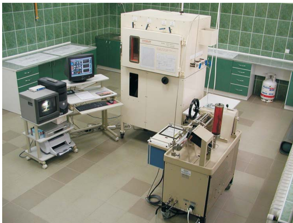
Ryc. 4. Aparatura do badań przemian fazowych PVT w INiG, Oddział Krosno. Fot. M. Warnecki Fig. 4. Apparatus for PVT study of phase transitions in INiG, Krosno Branch. Photo M. Warnecki
