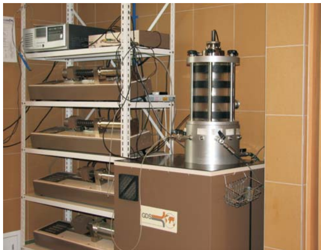
Ryc. 6. Aparat DYNNTTS; po lewej – sterowniki ciśnienia i objętości wody i powietrza; po prawej – komora trójosiowa. Fot. A. Bąkowska
