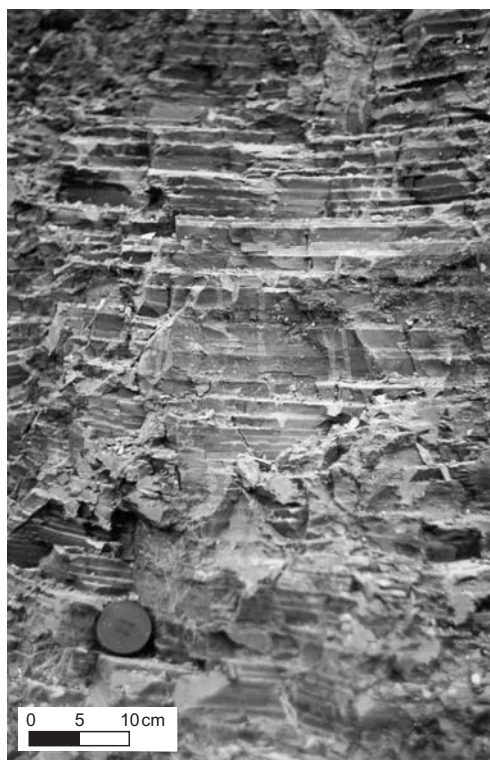
Ryc. 6. Ił warwowy z Plecewic, głębokość ok. 7 m Fig. 6. Varved clay from Plecewice, depth about 7 m
