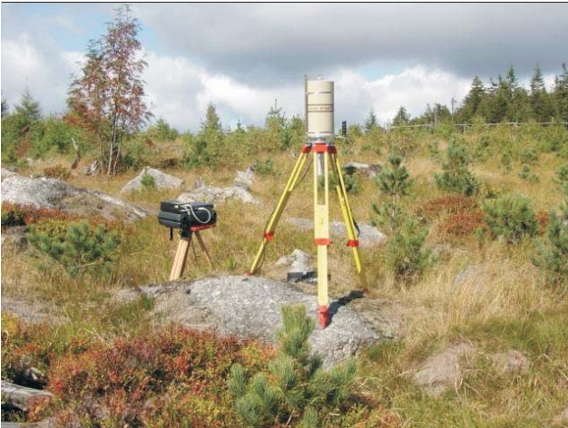
Ryc. 2. Przenośny system spektrometryczny promieniowania gamma podczas pomiaru na granitach izerskich (punkt 9) Fig. 2. Portable gamma-ray spectrometry workstation during measurement in Izer granite (site 9)
