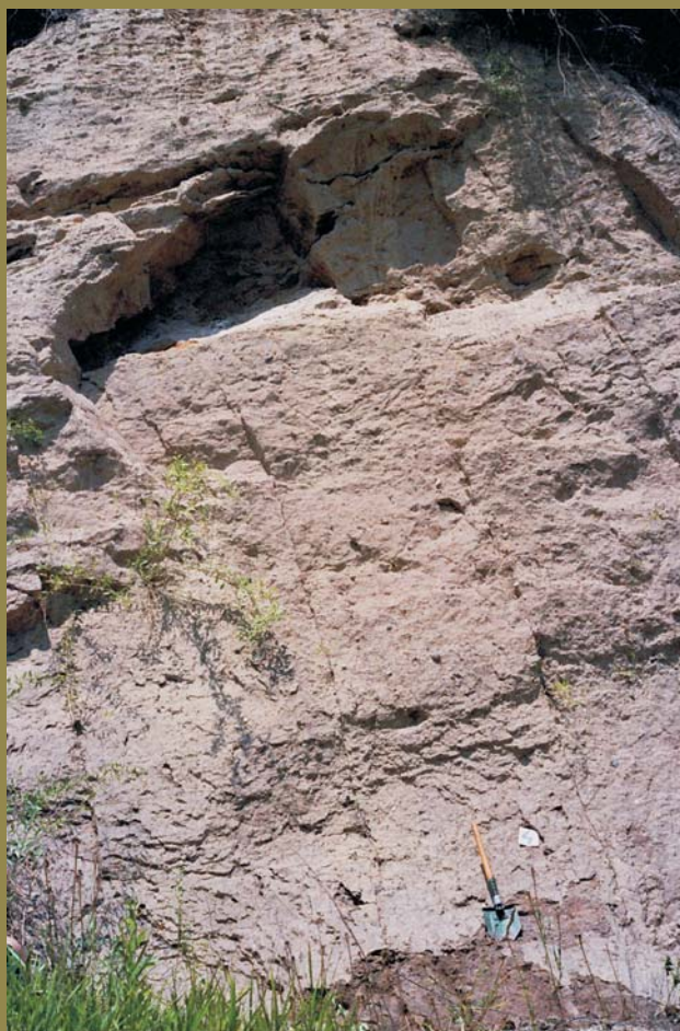
Ryc. 2. Spękania w wyszogrodzkich glinach lodowcowych — predyspozycja dla rozwoju procesów geodynamicznych; fot. 1, 2 B. Malinowska
