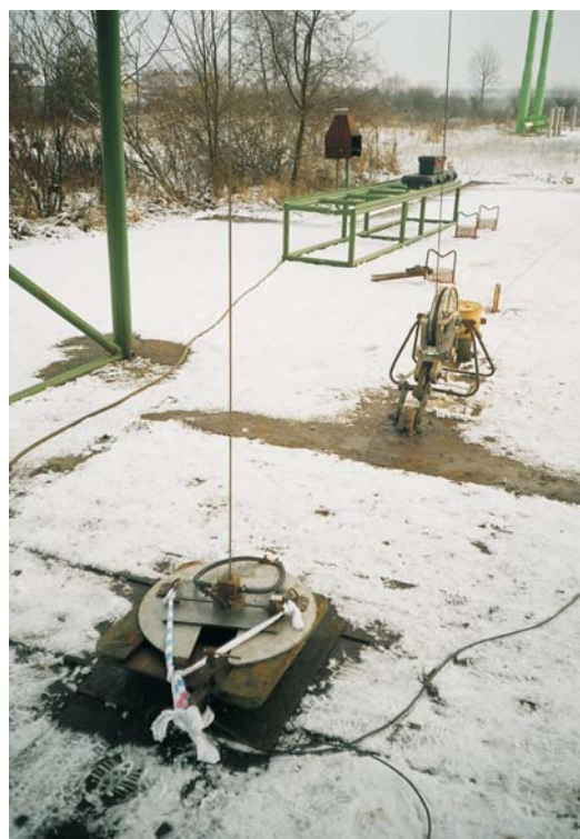
Ryc. 1. Otwór Toruń–1. Pomiar temperatury po dwudziestu pięciu latach od zakończenia prac wiertniczych
