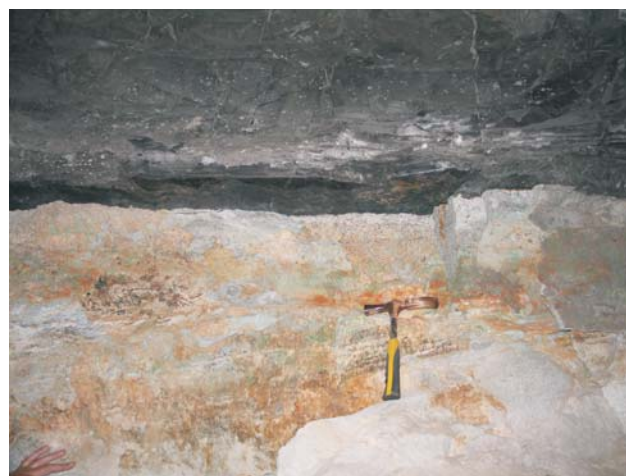
Ryc. 5. Zaburzenia profilu litologicznego złoża związane ze skłonem Północnej Elewacji Rudnej . W profilu obserwuje się od dołu: piaskowiec kwarcowy o spoiwie ilastym, cienką warstwę łupków miedzionośnych i dolomit wapnisty. Fot. I.B. Litwin
