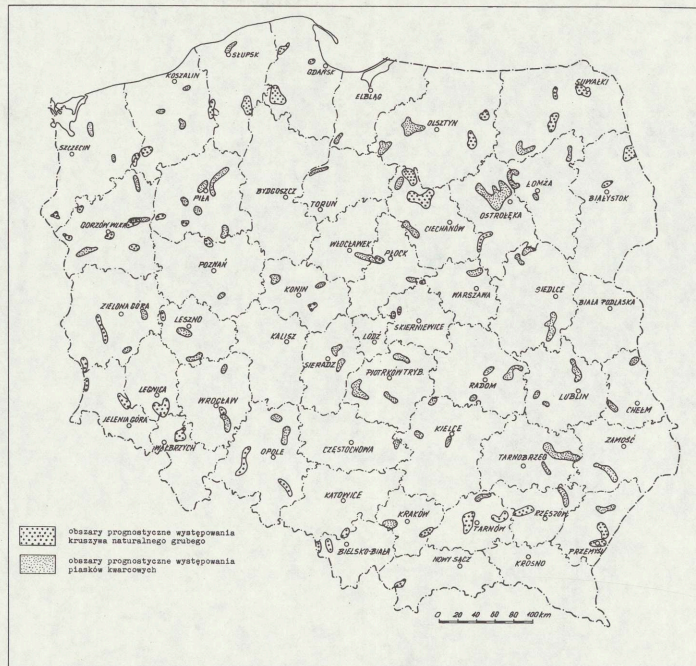
Fig. 36. Obszary prognostyczne kruszywa naturalnego grubego i piasek kwarcowych do produkcji cegły silikatowej i betonów komórkowych /Z. Siliwończuk, M. Gientka, R. Kordaś/
