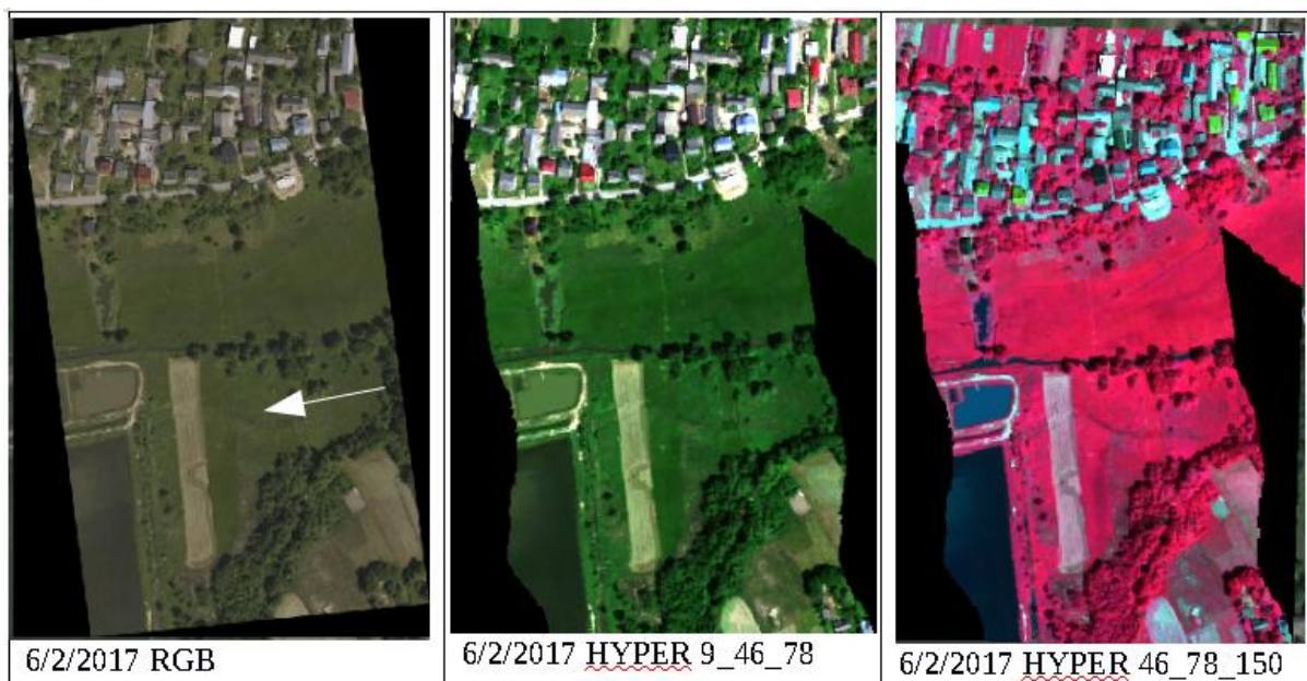
Rysunek 34 Droga ekspresowa S19 Polichna Pierwsza – ode lewej: RGB FOTO, kompozycje z obrazów hiperspektralnych RGB i FCC, analiza obszarów nadmiernie uwilgotnionych
