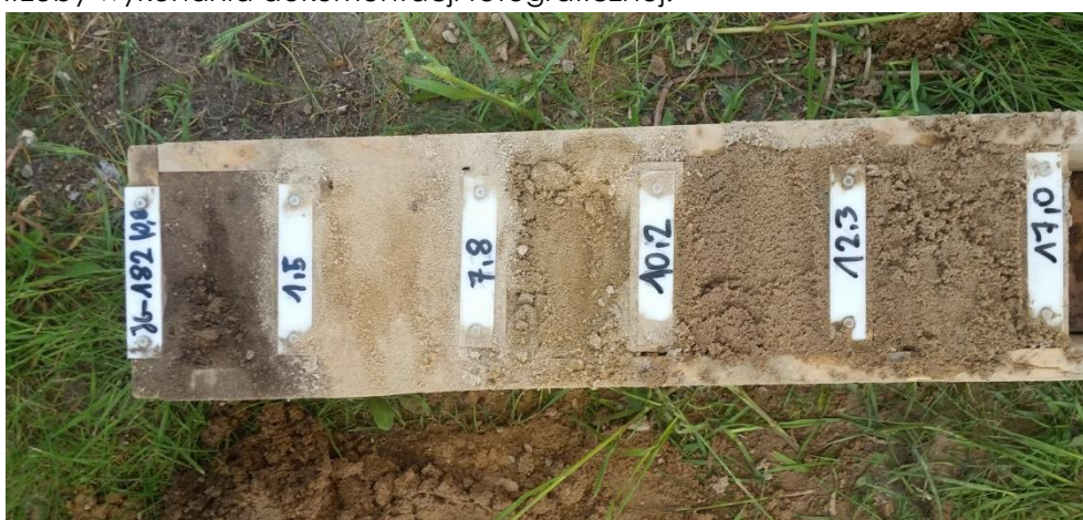
Fot. 1 Przykład dokumentowania fotograficznego przewiercanych gruntów
