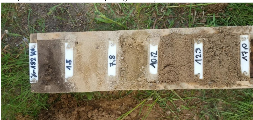
Fot. 1 Przykład dokumentowania fotograficznego przewiercanych gruntów
