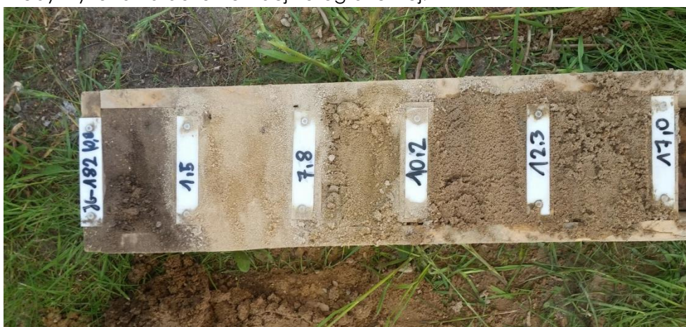
Fot. 1 Przykład dokumentowania fotograficznego przewiercanych gruntów
