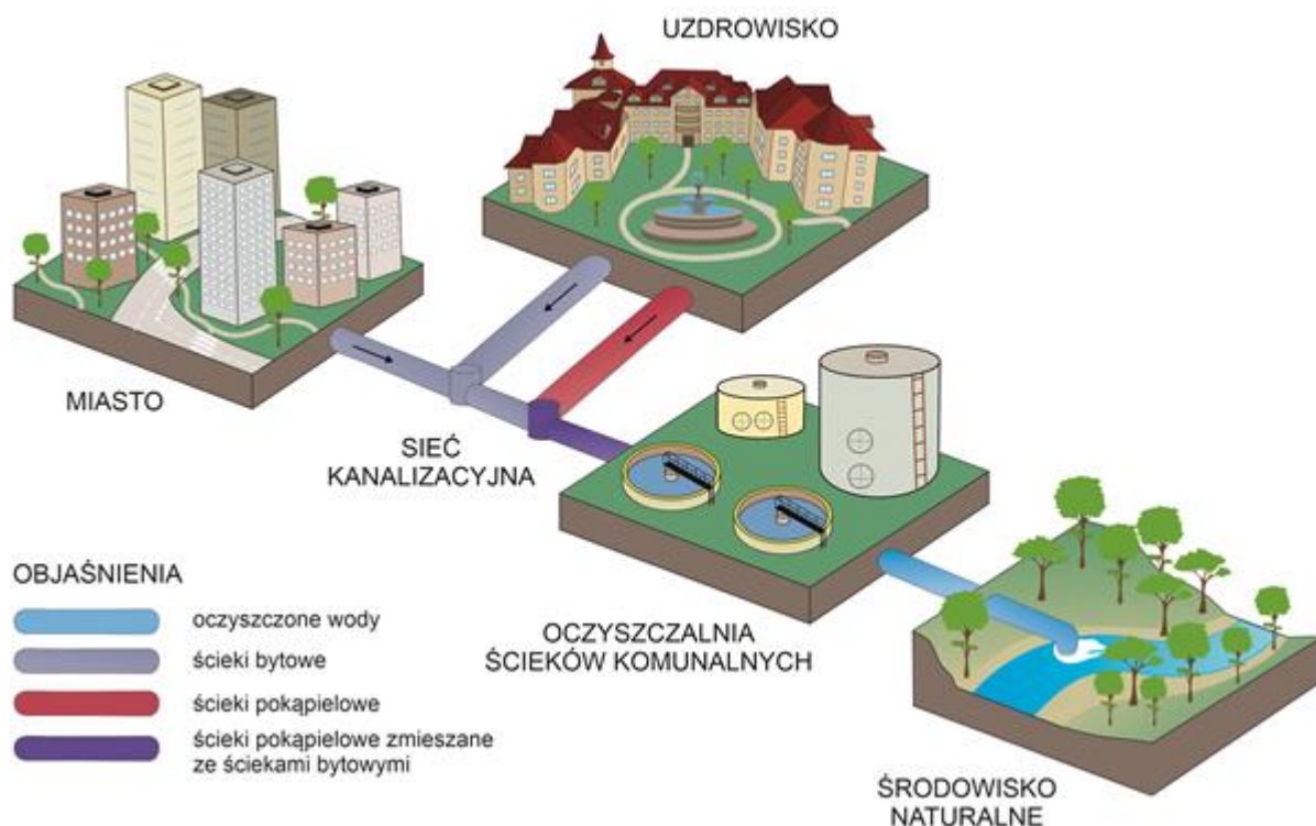
Fig. 6.1. Schemat zalecanego sposobu odprowadzania ścieków pozabiegowych o niskiej mineralizacji i niskiej zawartości składników chemicznych powodujących degradację środowiska (na podstawie https://www.nik.gov.pl )
