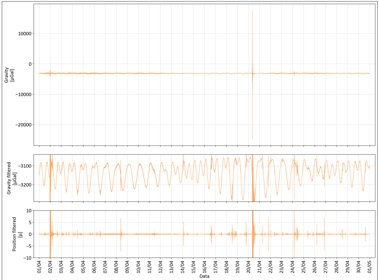
Rys. 9. Zmiany pionowej składowej siły ciężkości g zarejestrowane w okresie od 01/04/2026 do 30/04/2026 r. w laboratorium geodynamicznym PSG w Hołownie; zmiany składowej pionowej przyspieszenia siły ciężkości (górny wykres), zmiany składowej pionowej przyspieszenia siły ciężkości po filtracji dolnoprzepustowej (środkowy wykres), podwójnie przecałkowane, zredukowane zmiany składowej pionowej przyspieszenia siły ciężkości po filtracji dolnoprzepustowej (dolny wykres).
