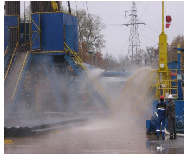
Pompowanie metodą air-lift otworu Toruń GT-1 (fot. S. Forst)
