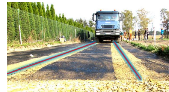
Instalacja światłowodowych czujników odkształceń w warstwach podbudowy z pianobetonu oraz widok konstrukcji drogi z czasu obciążeń próbnych
