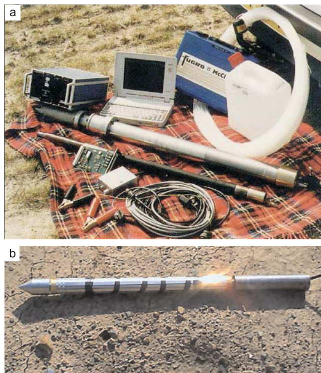
Rys. 7.50. Presjometr wciskany typu PIP ( pushed-in pressuremeter ) stosowany w połączeniu z badaniem CPTU: a – zestaw przykładowy, b – końcówka sondy CPTU z modulem presjometrycznym
