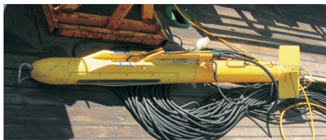
Rys. 7.4. Przetwornik sonaru bocznego skanującego typu ryba
