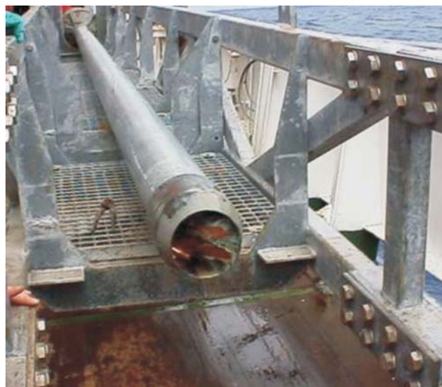
Rys. 7.24. Długa rdzeniówka na rusztowaniu wyciągarki
