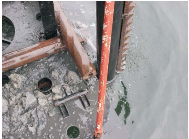
Rys. 10.6. Resztki gruntu pozostające na dnie ramy Rosona oraz w rozmieszczonych co 10 cm kieszeniach, służących do oceny głębokości zanurzenia ramy w słabych osadach dennych
