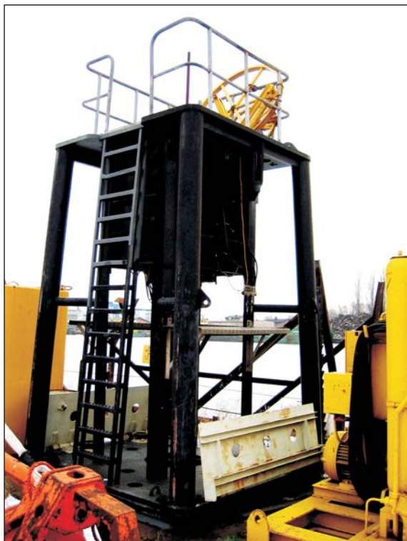
Rys. 7.37. Rama systemu ROSON 100 kN do wykonywania sondowania statycznego
