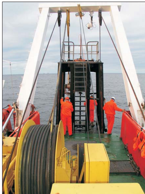
Rys. 7.38. Bramownica do wystawiania ramy systemu ROSON 100 kN poza rufę statku
