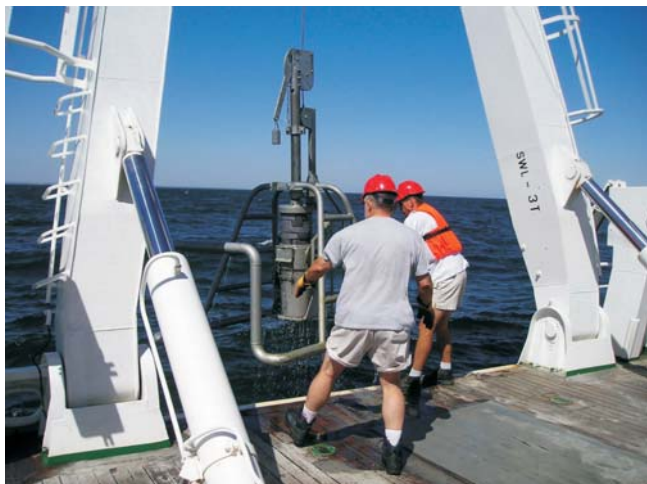
Rys. 7.28. Próbnik skrzyniowy podczas wyciągania na pokład statku r/v IMOR
