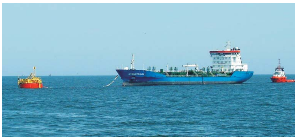
Rys. 10.14. Boja cumowniczo-przelewowa z tankowcem oraz utrzymującym jego pozycję holownikiem na Morzu Bałtyckim w Morskiej Kopalni Ropy na złożu B8
