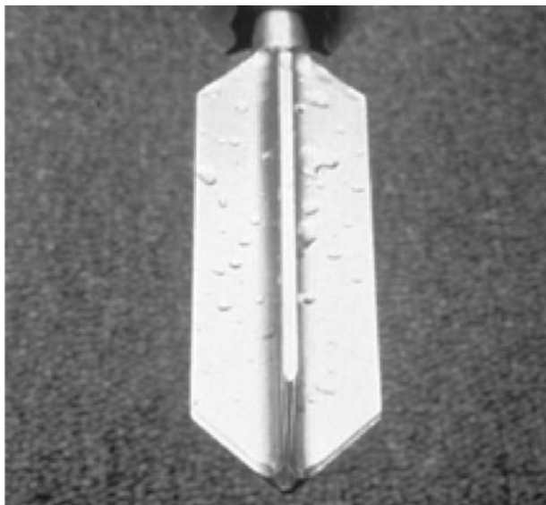
Rys. 7.52. Przykład końcówki sondy krzyżakowej o skrzydełkach ściętych trapezowo
