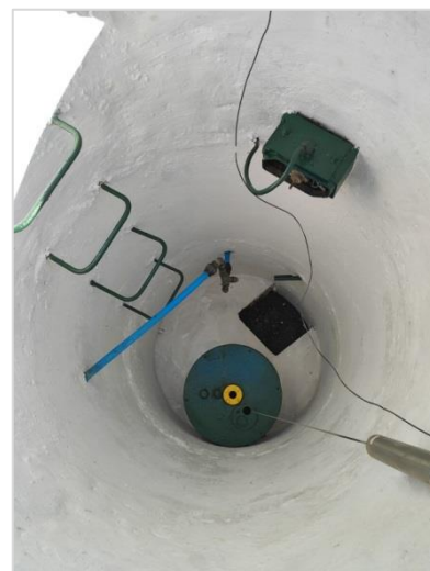
Ryc.10.5. Punkt SOBWP numer II/334 Koszarsko (woj. lubelskie) po wykonaniu prac remontowych. po prawej widoczny moduł automatyki pomiarowej.
