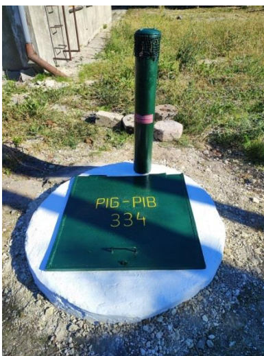
Ryc.10.5. Punkt SOBWP numer II/334 Koszarsko (woj. lubelskie) po wykonaniu prac remontowych. po prawej widoczny moduł automatyki pomiarowej.
