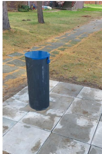
Ryc.10.7. Zabezpieczenie otworów obserwacyjnych II/1518/1 (woj. lubelskie) i II/849/1 Słupiec (woj. małopolskie).
