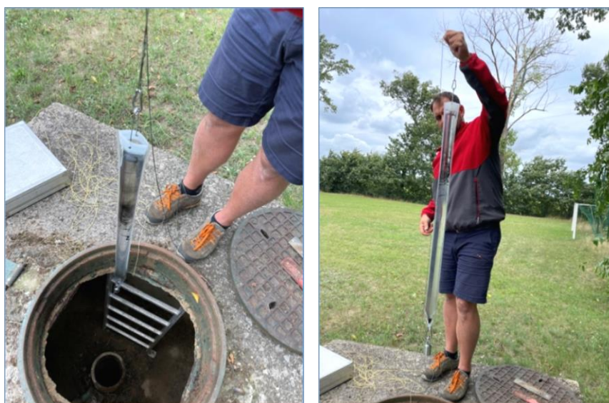
Ryc. 4.1. Przebieg opróbowania metodą Hydrasleeve.
