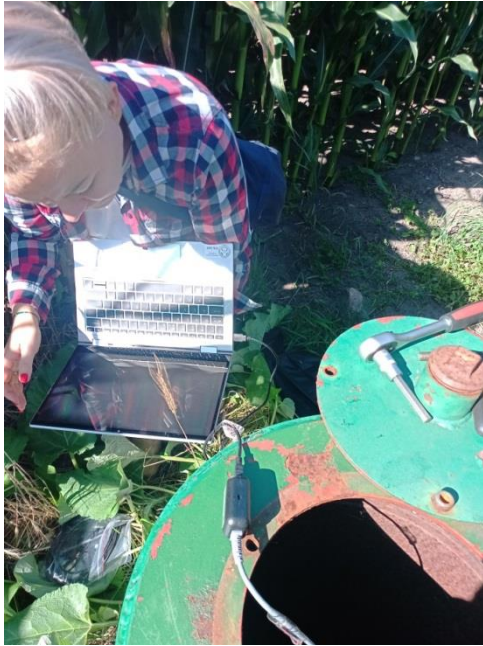
Ryc. 2.1. Prace serwisowe na stacji hydrogeologicznej wyposażonej w automatyczne urządzenia pomiarowe.
