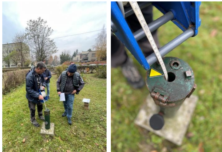
Ryc. 4.1. Pomiary poziomu głębokości wód podziemnych w otworach hydrogeologicznych prowadzone w trakcie realizacji badań biegłości poprzez porównania między laboratoryjne (PT/ILC) – Sosnowiec 7.11.2024 r.
