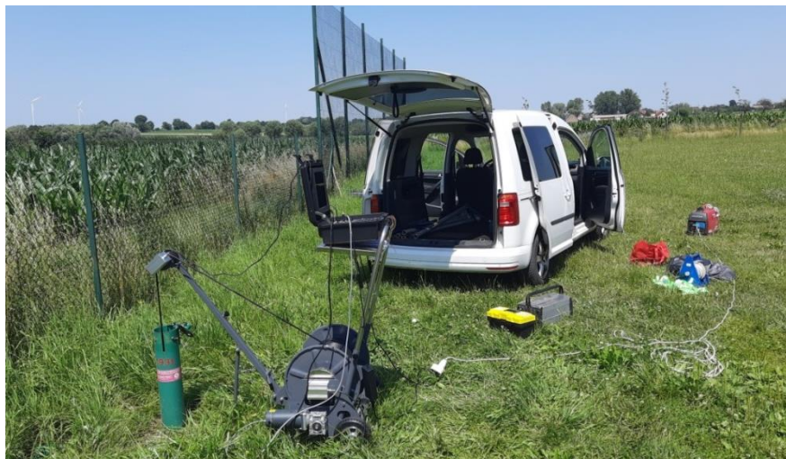
Ryc. 9.2. Inspekcja specjalistyczną kamerą otworu ID 8513 Wielowieś.
