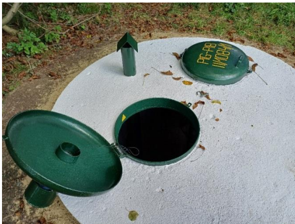
Ryc.10.4. Punkt SOBWP numer II/1084 Ewunin (woj. lubelskie) po wykonaniu prac remontowych. po prawej widoczny moduł automatyki pomiarowej.
