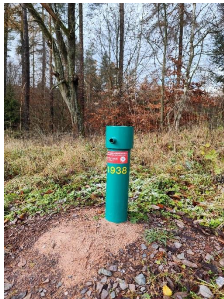
Ryc. 10.2. Punkt obserwacyjny II/1938/1 Łączna (woj. dolnośląskie) w trakcie prac związanych z wymianą obudowy piezometrycznej.
