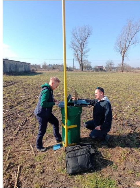
Ryc. 2.1. Prace serwisowe na stacji hydrogeologicznej wyposażonej w automatyczne urządzenia pomiarowe.
