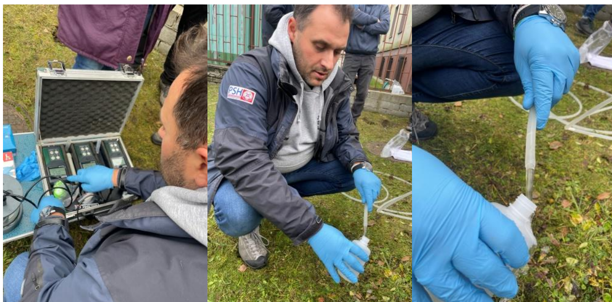
Ryc. 4.2. Pomiary parametrów fizykochemicznych wód podziemnych metodą „in situ” oraz pobieranie próbek wód podziemnych prowadzone w trakcie realizacji badań biegłości poprzez porównania między laboratoryjne (PT/ILC) – Sosnowiec 7.11.2024 r.
