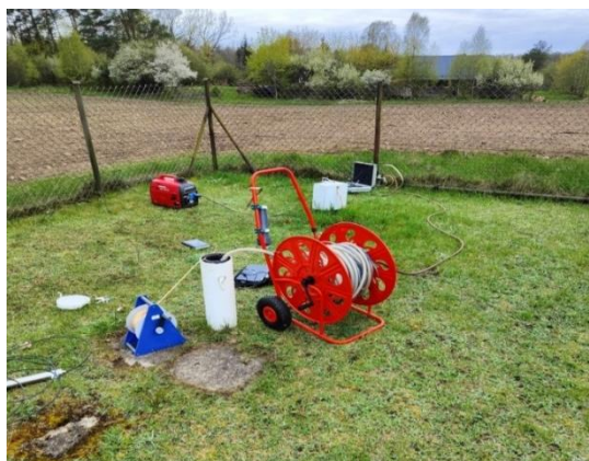
Ryc. 9.1. Pompowanie sprawnościowe punktu ID 438 Sobolewo.
